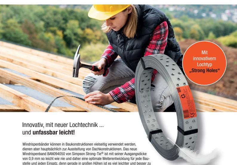
Bei der Entwicklung hat man auf diesen neuartigen Lochtyp gesetzt, den sogenannten "Strong Holes". Diese Löcher werden nicht gestanzt, sondern durch Verdrängen des Materials hergestellt. Diese Produktionsmethode bewirkt, dass die Tragfähigkeit im Vergleich zu Bändern mit gestanzten Löchern nicht reduziert werden muss. Das neue Windrispenband ist eine Innovation, deren Vorteile sich bei Ihren Projekten sicher auszahlen.
