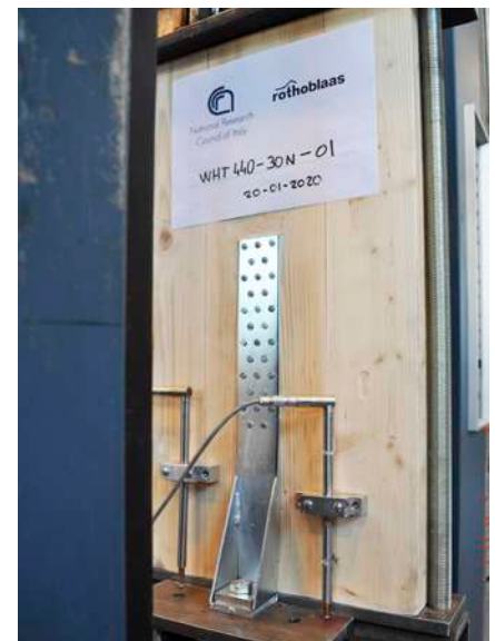
Versuchsreihe an BSP-Platten (C24) (CNR-IBE St. Michael an der Etsch, 2020).
