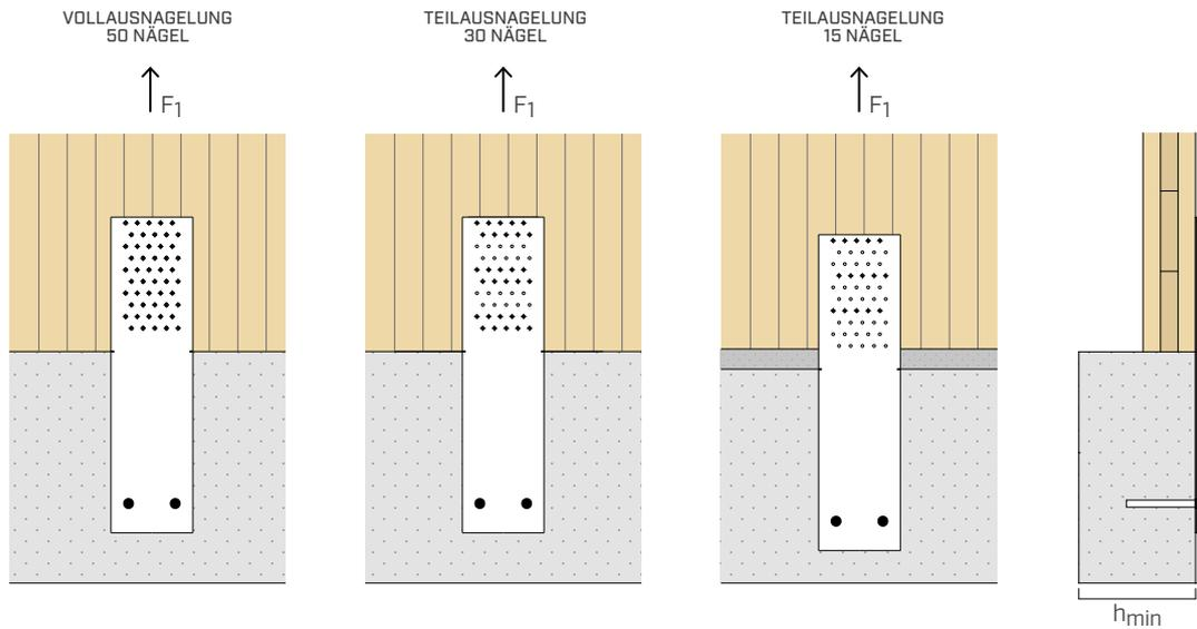
MINDESTBREITE BETON  $h_{min} \geq 200$  mm
