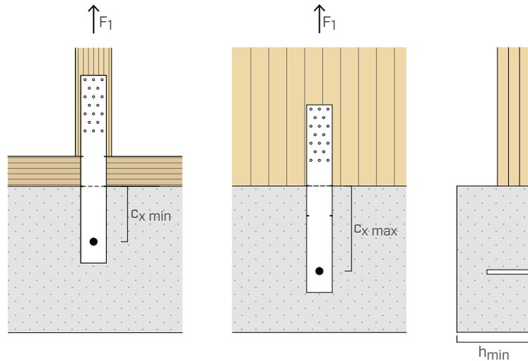
MINDESTBREITE BETON  $h_{min} \geq 200$  mm
