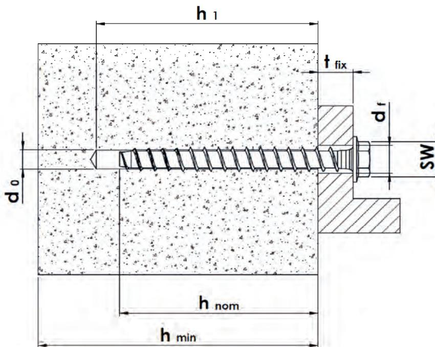
Schraubanker MULTI-MONTI-plus zur Verwendung im Mauerwerk
