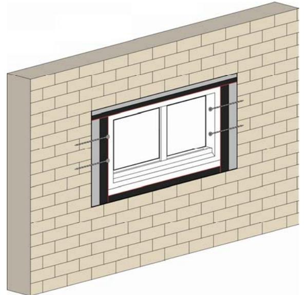
Für den Brüstungsbereich wird das schmalere Winflex® TriSave für die Brüstung, das speziell für die Verwendung in Verbindung mit einem Basisprofil gedacht ist, mit jeweils 0,5 cm Überstand links und rechts unter das Basisprofil angebracht.
