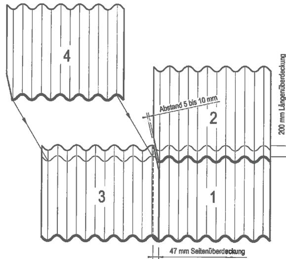
Bild 5: Überdeckungen und Eckenschnitte der Platte P5 und P6
