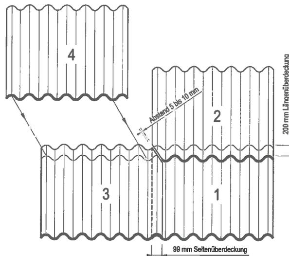
Bild 6: Überdeckungen und Eckenschnitte der Platte P6  $\frac{3}{4}$
