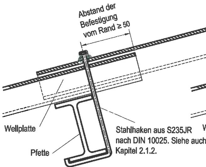
Bild 8: Anordnung der Befestigung bei Stahlpfetten mit Haken
