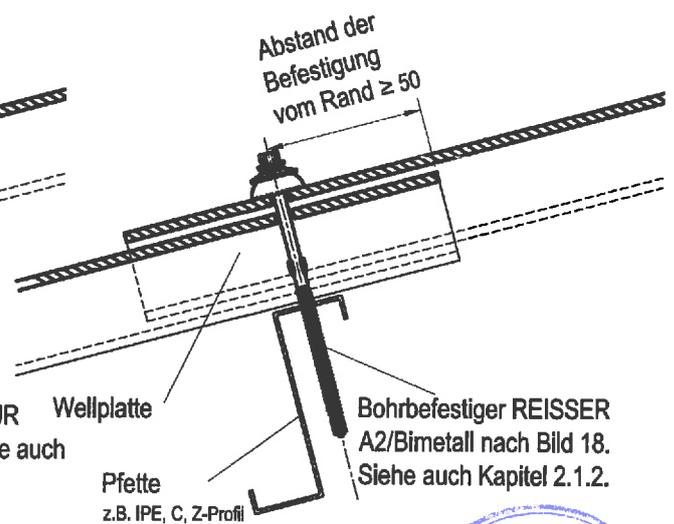
Bild 8a: Anordnung der Befestigung bei Stahlpfetten mit Bohrbefestigern
