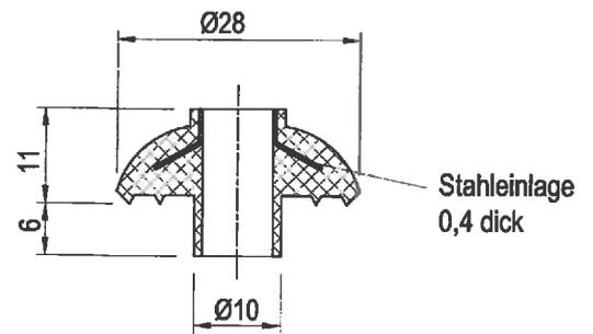
Bild 9: Pilzdichtung
