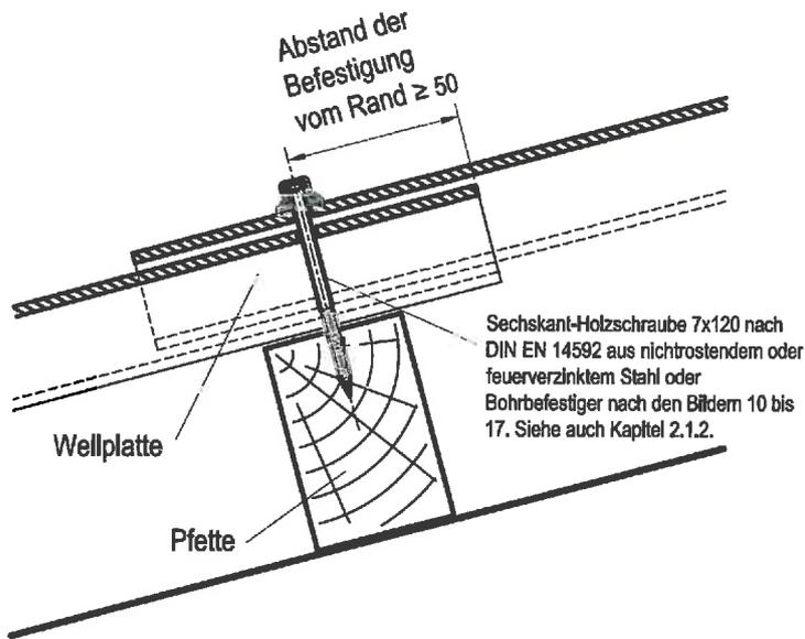
Bild 7: Anordnung der Befestigung bei Holzpfetten
