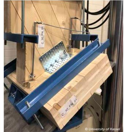
Abbildung 1. 30° Aufbau bei einer 60°-Belastung.
