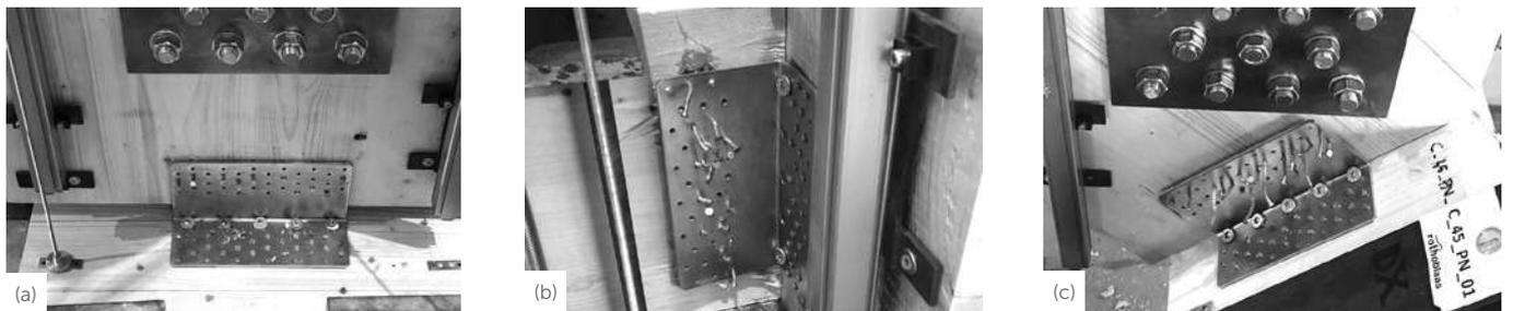
Abbildung 2. Proben am Ende der zyklischen Tests: Zug (a), Scherung (b) und 45° (c) (Teilausnagelung).
