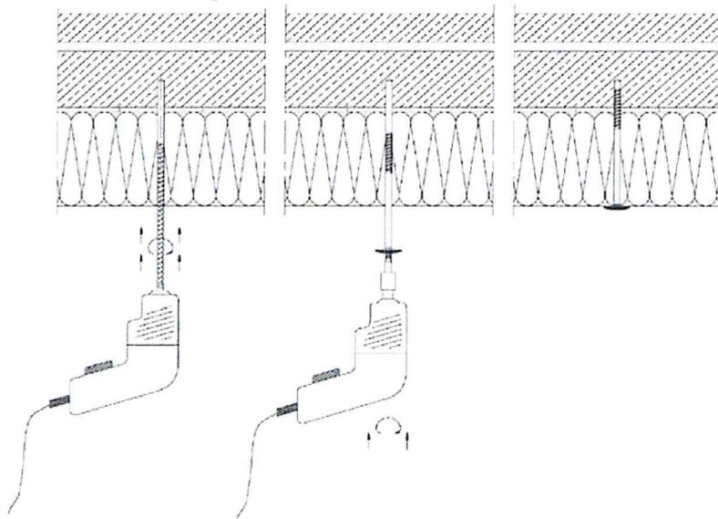
EJOT DDS zur Befestigung von Dämmstoffen an Betonbauteilen
