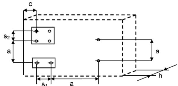
**Tabelle B4.2: Minimale Bauteildicke, Randabstand und Achsabstand in Porenbeton (PB)**
