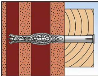
5. Richtig gesetzter Dübel in Hohlmauerwerk.
