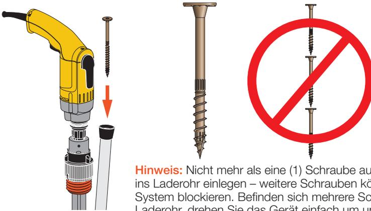
**Hinweis:** Nicht mehr als eine (1) Schraube auf einmal ins Laderohr einlegen – weitere Schrauben könnten das System blockieren. Befinden sich mehrere Schrauben im Laderohr, drehen Sie das Gerät einfach um und lassen Sie sie herausfallen.
