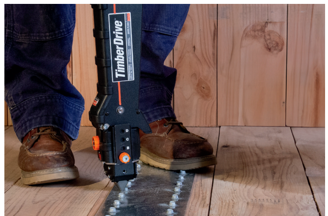
Präzisions-Anschlag für Holz-Metall-Verbindungen
