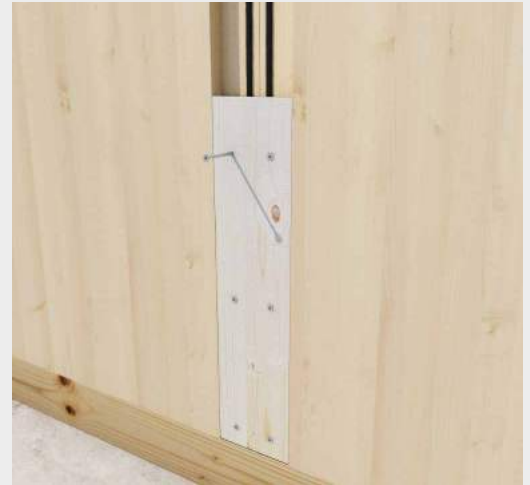
Befestigung von BSP-Wänden mit 6 mm HBS.
