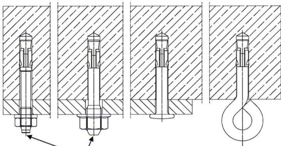
Zusätzliche Markierung nur bei galvanisch verzinktem Stahl für  $h_{ef} = 25$  mm (Zentrierung, Balken oder Punkt)
