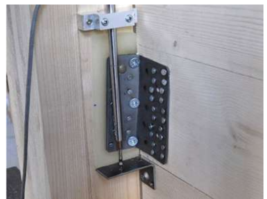
Monotoner Scherversuch ( F_{2/3} ) an NINO15080 in Holz-Holz-Konfiguration.
