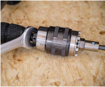
Den TORQUE LIMITER auf den richtigen Drehmomentwert einstellen.
