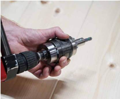
Die äußere Einschraubhülse drehen, um den TORQUE LIMITER zurückzusetzen.
