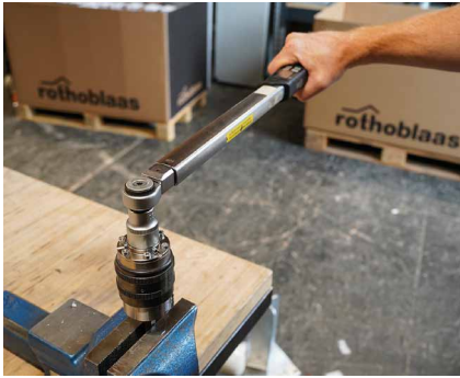
Eine erste Überprüfung des Drehmoments mit einem Drehmomentschlüssel durchführen.
