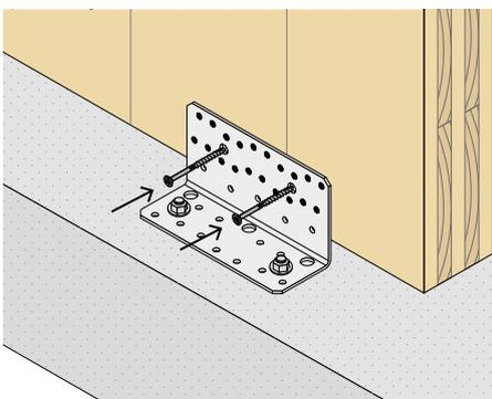
Positionierung der Wände mithilfe von Ø6 oder Ø8 Schrauben zum Heranführen der Platte an den Winkelverbinder.
