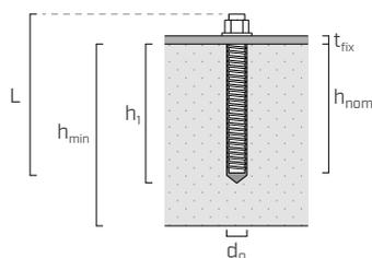
$t_{fix}$  Stärke der befestigten Platte
