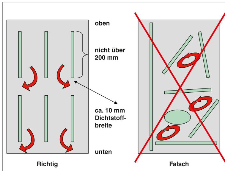
Bei der Montage von Spiegeln an Decken und bei der Wandmontage von Spiegeln, deren Oberkante über 4 m über der Bodenfläche liegt, müssen die Spiegel zusätzlich mechanisch z.B. durch Schrauben bzw. Einlegen in Rahmen gesichert werden.
