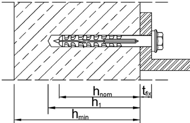
**Anwendung in vorgespannten Hohlkammerdecken**
