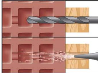
1. Bohrlocherstellung und Entfernung des Bohrmehls.
