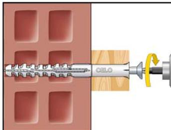
3. Schraube bündig eindrehen bis der Schraubenkopf und das anschließende Anbauteil an der Dübelhülse anliegt.
