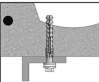
4. Richtig gesetzter Dübel (mit Schraube) in Hohlkammerdecke.
