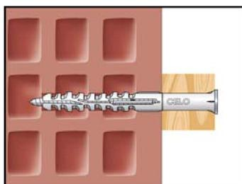
4. Richtig gesetzter Dübel (mit Schraube) in Beton bzw. in Mauerwerk.
