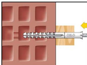
2. Dübel (Schraube mit Dübelhülse) mit einem Hammer einführen, bis der Rand der Dübelhülse bündig an der Oberfläche des Anbauteils anliegt. Die Mindestsetztiefe (50 bzw. 70 mm) muss eingehalten werden.
