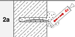
Das Bohrloch vom Bohrlochgrund her mit der Ausblaspumpe mind. **4x** vollständig ausblasen bis die ausströmende Luft staubfrei ist.
