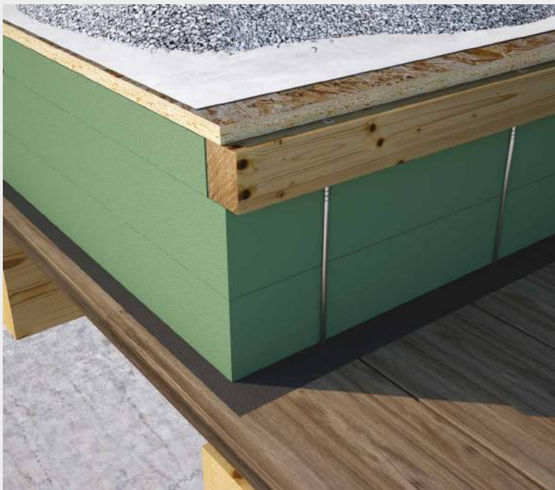
^ Befestigung von hartem Dämmstoff am Flachdach.
