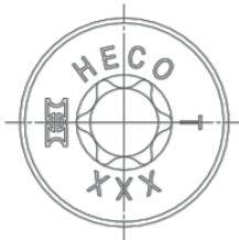
Kopfkennzeichnung bei d = 6,0 bis 10,0 der Ausführungen: Flachsenkopf. Genannte Kopfform auch ohne Beschriftung möglich.
