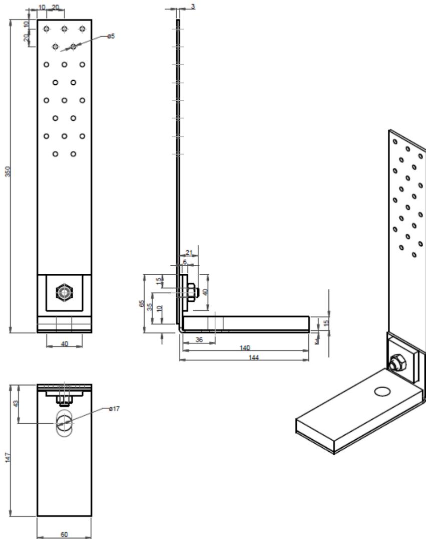
Figure B. 36 HT2-G-Druckplatte-lang-Z-316
