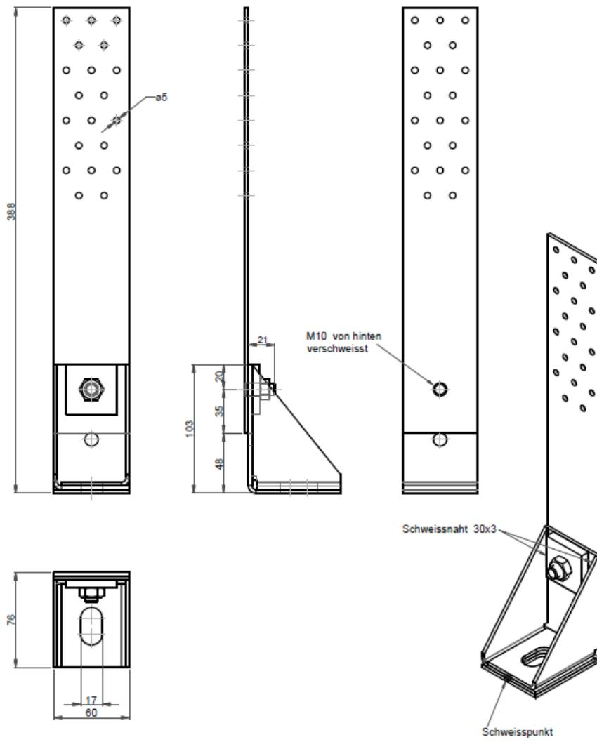
Figure B. 37 HT2-G-Stegwinkel-1Bo-Z-101
