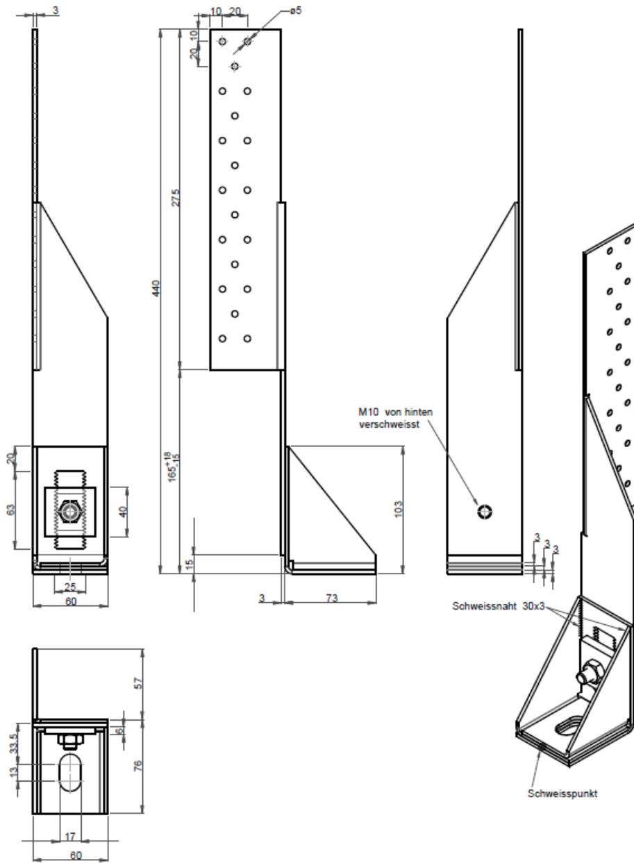
Figure B. 43 HT2-LV-425-Stegwinkel-Z-230
