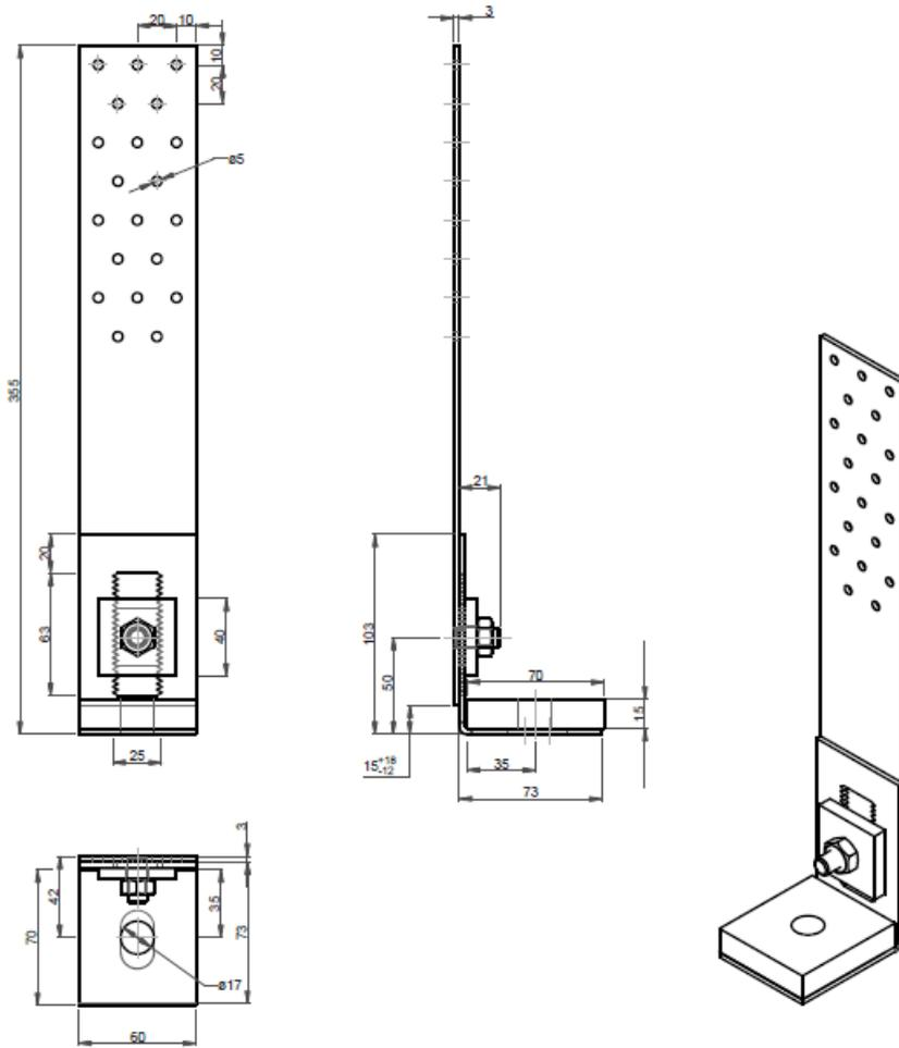
Figure B.39 HT2-GV-Druckplatte-kurz-Z-310
