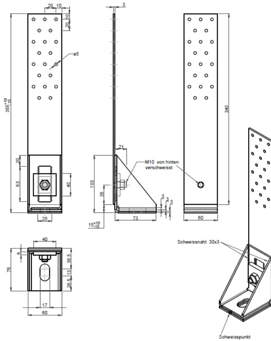
Figure B.41 HT2-GV-Stegwinkel-Z-100
