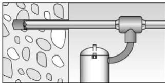
Die Bohrlocherstellung bis zur erforderlichen Setztiefe erfolgt dreh Schlagend mit einem Hammerbohrer (Hohlbohrer).
