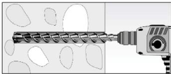
Die Bohrlocherstellung bis zur erforderlichen Setztiefe erfolgt dreh Schlagend mit einem Hartmetall-Hammerbohrer oder Pressluftbohrer.
