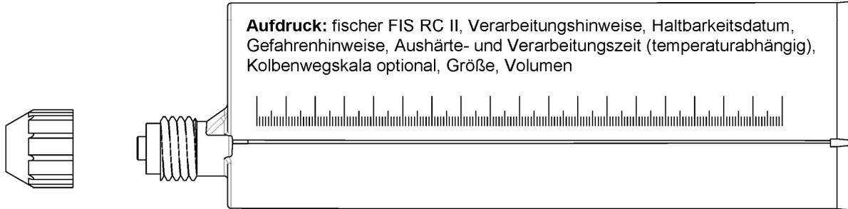
**Injektionskartusche (Coaxialkartusche) FIS RC II mit Verschlusskappe; Größen: 300 ml, 380 ml, 400 ml, 410 ml**
