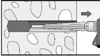
Das Bohrloch vom Grund her mit Mörtel verfüllen. Bei jedem Hub den Statikmischer langsam zurückziehen. Luftblasen sind zu vermeiden. Das Bohrloch zu ca. 2/3 mit Mörtel verfüllen, um sicher zu gehen, dass der Ringspalt zwischen Betonstahl und Beton über die gesamte Einbindetiefe vollständig verfüllt ist. Die Bedingungen für die Mörtelinjektion ohne Verlängerungsschlauch sind in **Tabelle B5.3** zu entnehmen
