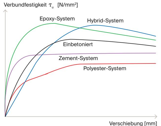
Beispiel:  $d_s = 20 \text{ mm}$   $l_v = 300 \text{ mm}$  C20/25
