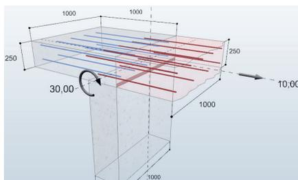
Anschluss Platte / Platte mit Auflager
