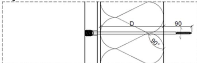
4. Justieren: Wird das Einschraubwerkzeug nur soweit eingesteckt, dass der äußere Ring zu sehen ist, kann man die Traglatte vor der Dämmung verstellen.
