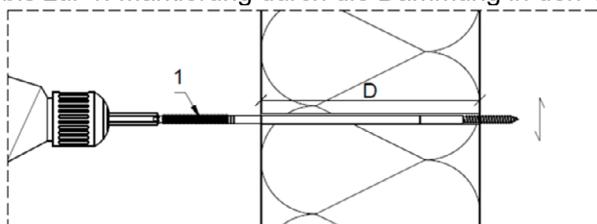
Bei Bedarf kann harter Dämmstoff mit einem geeigneten Bohrer  $\varnothing$  8 bis  $\varnothing$  10 mm vorgebohrt werden.
