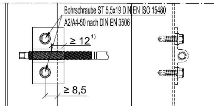
Der Profilverbinder ist für die Anflanschung von Standard Fassadenprofilen mit den folgenden Mindestabmessungen vorgesehen:
