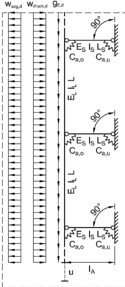
Statisches System bei einer 90°- und 75°-Verschraubung im Wechsel (mit Aussteifung):
