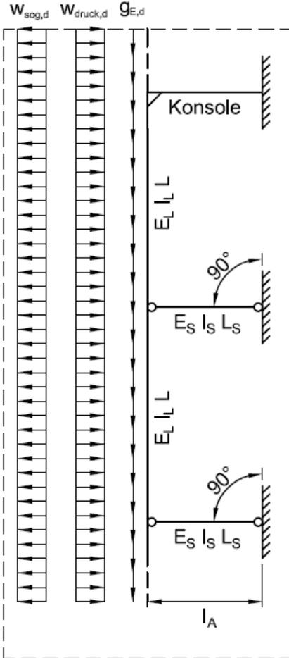
Statisches System bei einer 90°-Verschraubung (ohne Aussteifung):
