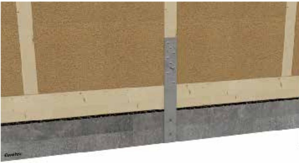
**Schritt 2:** Verankerung im Beton durch die dafür vorgesehenen Löcher  $\varnothing$  14 mm.
