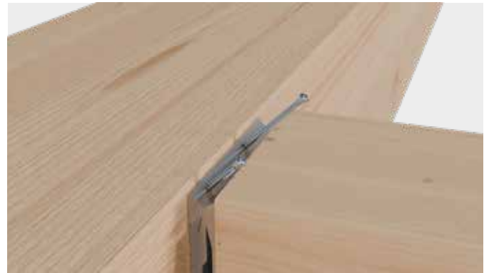
Schritt 4: Befestigen Sie den Connecto schließlich mit den mitgelieferten Sicherungsschrauben (Ø 5 mm).
