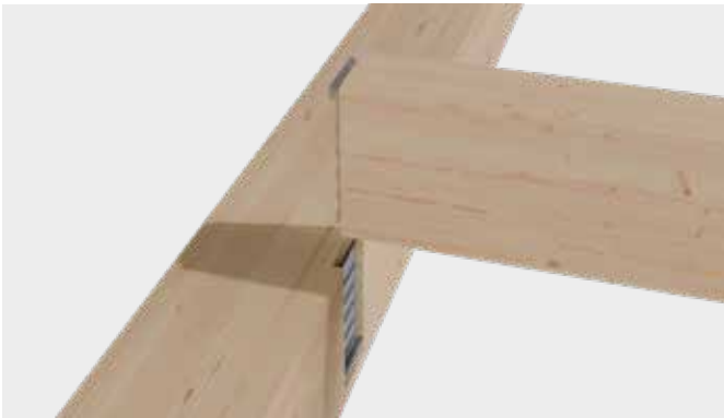
Schritt 3: Haken Sie den Nebenbalken von oben nach unten ein. Stellen Sie sicher, dass beide Connecto-Teile parallel zueinander ausgerichtet sind, um übermäßige Spannungen bei der Montage zu vermeiden.
