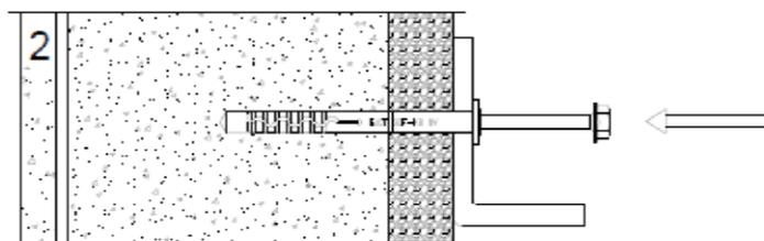
Die Schraube wird eingeschraubt, bis der Schraubenkopf die Dübelhülse berührt
