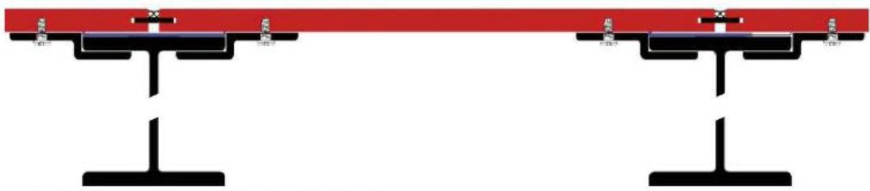
Balkonbodenplatte auf Stahlträger verdeckt befestigt (geschraubt)
