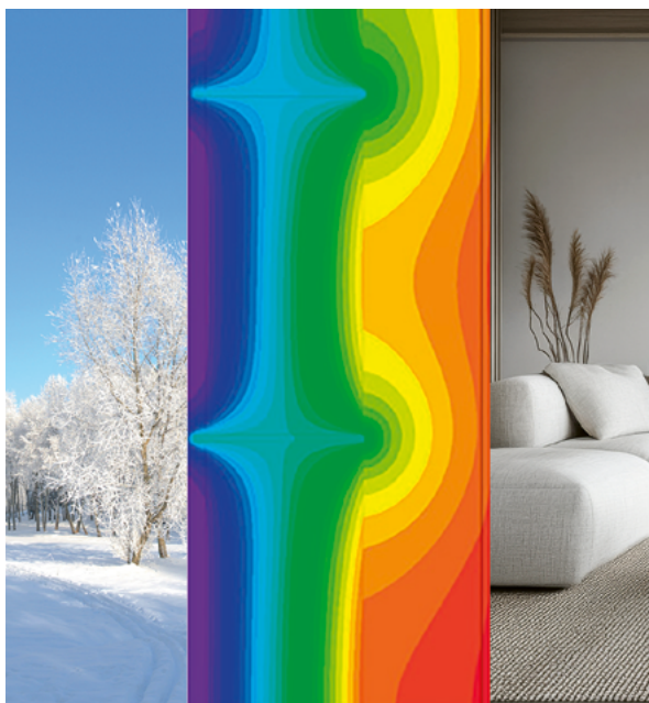
Abbildung 1 Ausgeprägte Wärmebrücke bei Aluminiumkonsolen
