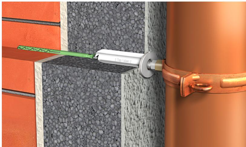
Beiliegendes Reduzierstück ermöglicht die Befestigung von Anbauteilen durch Grobgewindeschrauben  $\varnothing$  5 und  $\varnothing$  6 mm.
