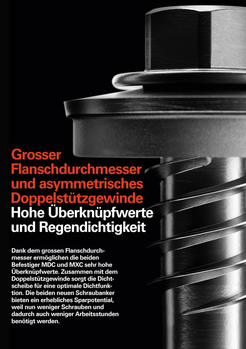
Bei der Entwicklung der neuen Betonanker konnten verschiedene wichtige Funktionsmerkmale kombiniert werden. Der asymmetrische Gewindegang mit grösseren Wirkflächen im Beton sowie das optimierte Gewinde ermöglichen höhere Tragfähigkeiten. Der höhere Aussendurchmesser am lastabtragenden Teil gewährleistet eine bessere Hinterschneidung im Beton und somit ein leichtes Einschrauben.
