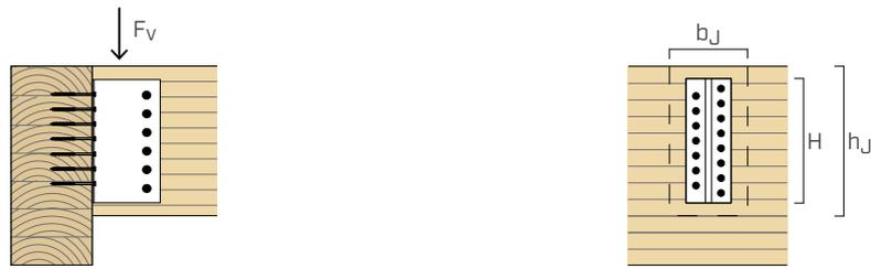
ALUMINI mit selbstbohrenden Stabdübeln SBD
