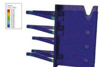
Vergleich Anfangszustand (unverformt) mit der Endkonfiguration der Prüfung
