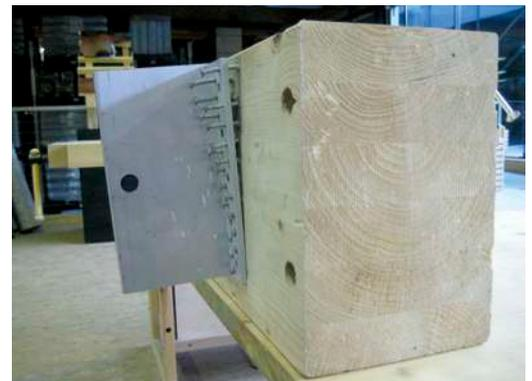
Prüfungen an Mustern mit realen Abmessungen (Verbindung Hauptträger - Nebenträger).
