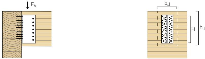
ALUMIDI mit selbstbohrenden Stabdübeln SBD
