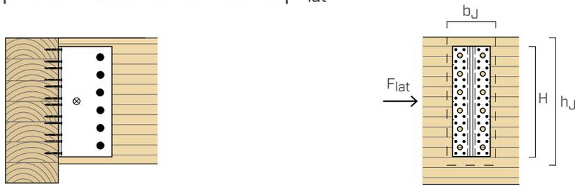
ALUMAXI mit selbstbohrenden Stabdübeln SBD und Stabdübeln STA
